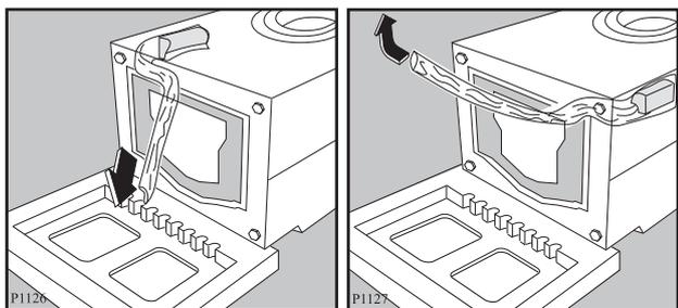
6. Поставьте машину в вертикальное положение, отвинтите и удалите оставшийся верхний болт. Выньте пластмассовую шпильку из отверстия, в которое был закручен болт.
