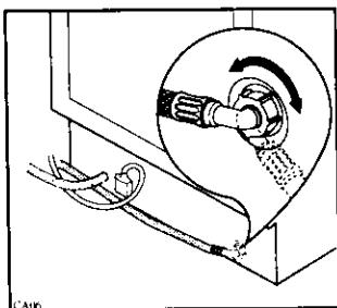
Прилагающийся к машине фильтр (A) следует установить изображённым на рисунке образом.
