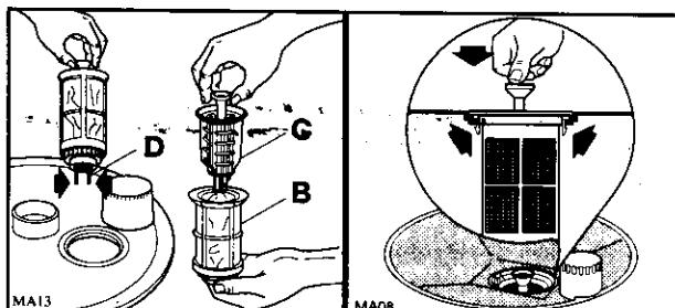
Для того чтобы снять фильтры (B) и (C), поднимите наружный фильтр (B) за имеющуюся в его центральной части воронку. Малый фильтр (C) снимается после этого посредством нажатия на два язычка (D).
