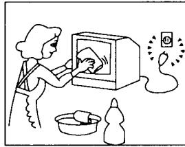
Для поддержания корпуса прибора и кинескопа в хорошем состоянии их достаточно протирать мягкой тряпкой, смоченной водным раствором моющего средства средней активности. Не применяйте растворы, содержащие бензол, бензин или другие химически активные вещества. В целях безопасности вынимайте сетевую вилку из розетки электросети во время уборки.
