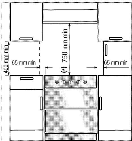
Для безопасности устанавливайте прибор на некотором расстоянии от мебели и от стены помещения. См. рисунок (размеры приведены в миллиметрах).
